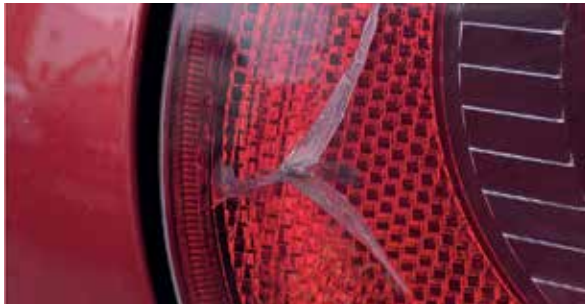
Puknuće stražnjeg svjetla
