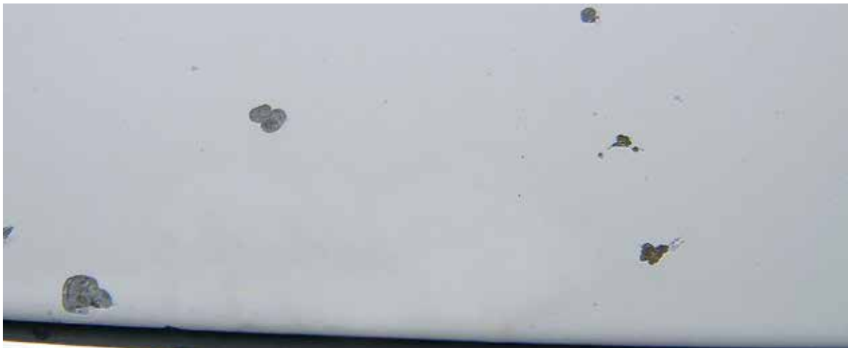
Više udara kamenom na površini 10 x 10 cm
