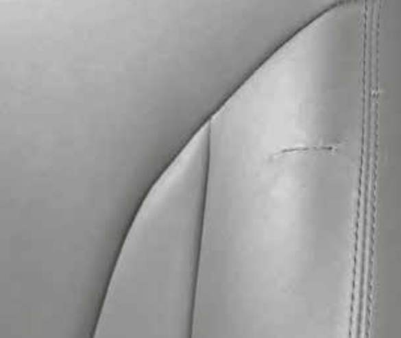
Pukotina u sjedalu
