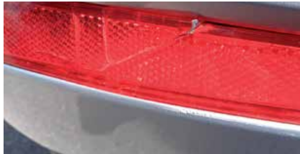
Puknuće malog stakla
