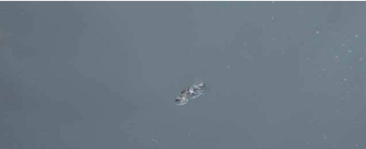
Lagana strugotina na vjetrobranskom staklu
