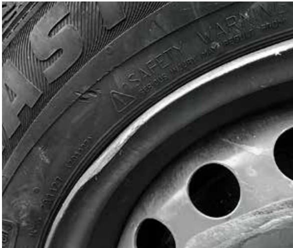
Jako oštećen aluminijski naplatak
