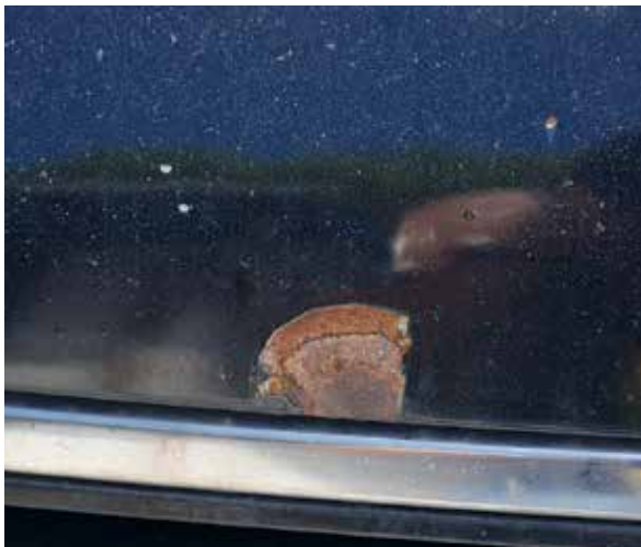
Veći udari kamena s korozijom
