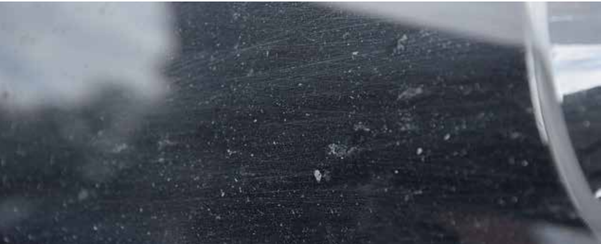
Udari sitnih kamenčića na malim staklenim dijelovima
