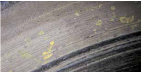
Pojava korozije na disku kočnice
