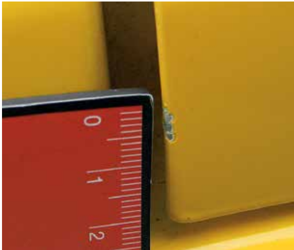
Oštećenje laka < 3 cm
