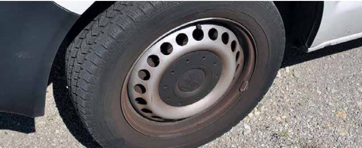
Površinska korozija bez oštećenja naplatka
