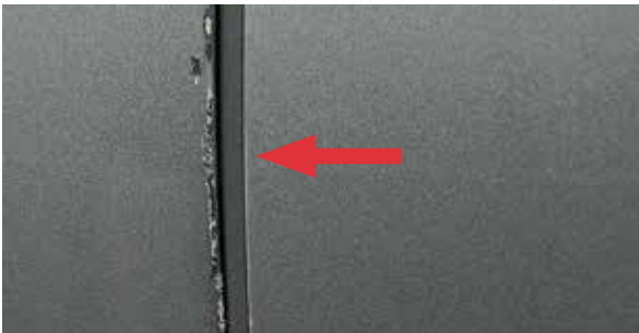
Oštećenje laka > 3 cm
