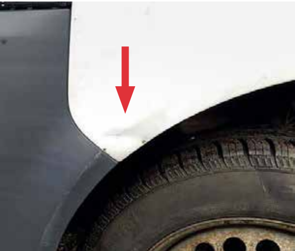
Veće oštećenje rubnjaka
