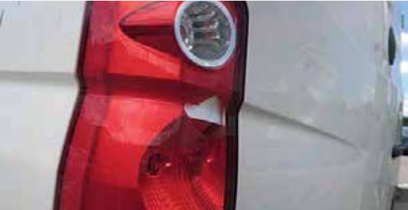
Puknuće stražnjeg svjetla
