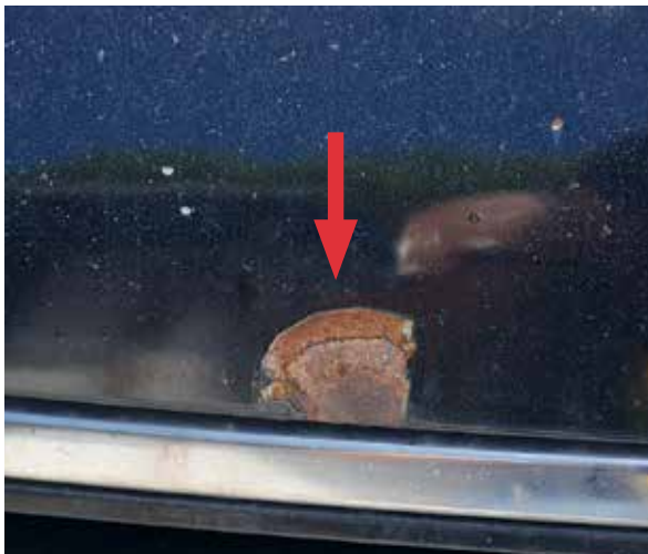
Veći udari kamena s korozijom
