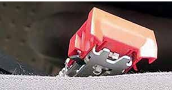
Oštećenje sigurnosnog pojasa
