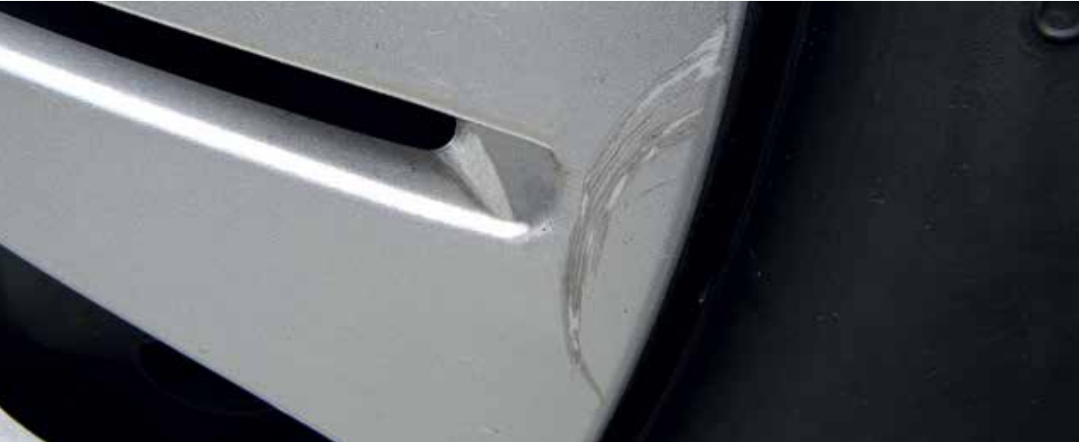
Manje pojedinačno oštećenje
