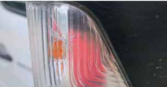
Oštećen pokazivač smjera
