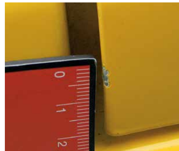
Oštećenje laka < 3 cm
