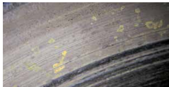
Pojava korozije na disku kočnice
