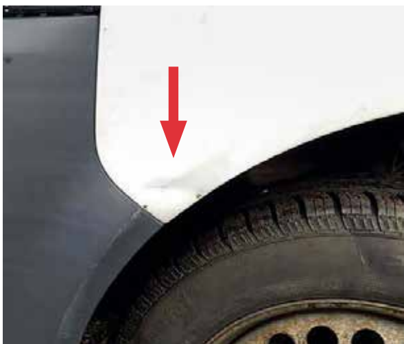
Veće oštećenje rubnjaka
