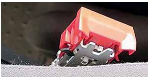
Oštećenje sigurnosnog pojasa
