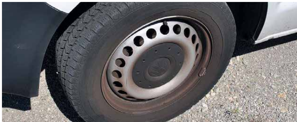
Površinska korozija bez oštećenja naplatka
