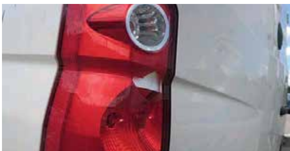
Puknuće stražnjeg svjetla
