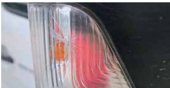
Oštećen pokazivač smjera
