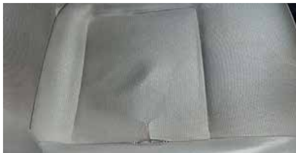
Pukotina u sjedalu
