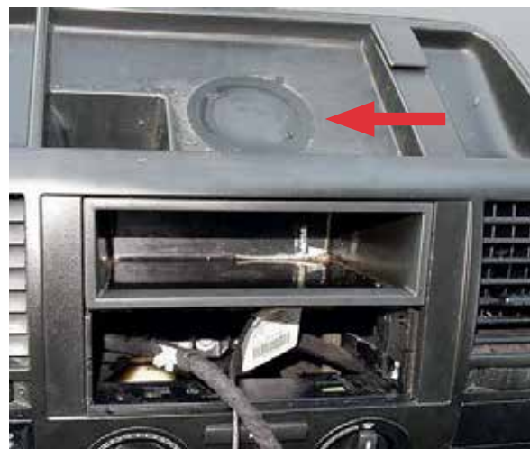
Promjena na upravljačkoj ploči koju više nije moguće dovesti u prvobitno stanje
