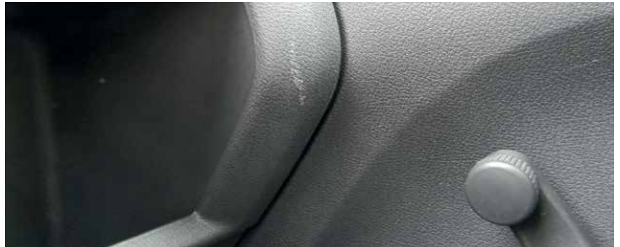
Mala ogrebotina na unutarnjim oblogama
