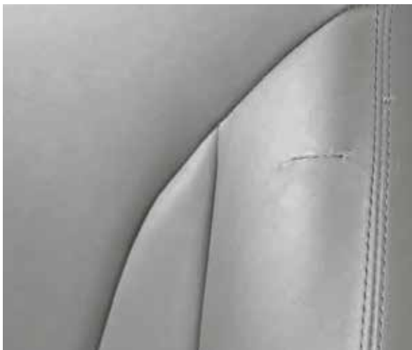
Pukotina u sjedalu
