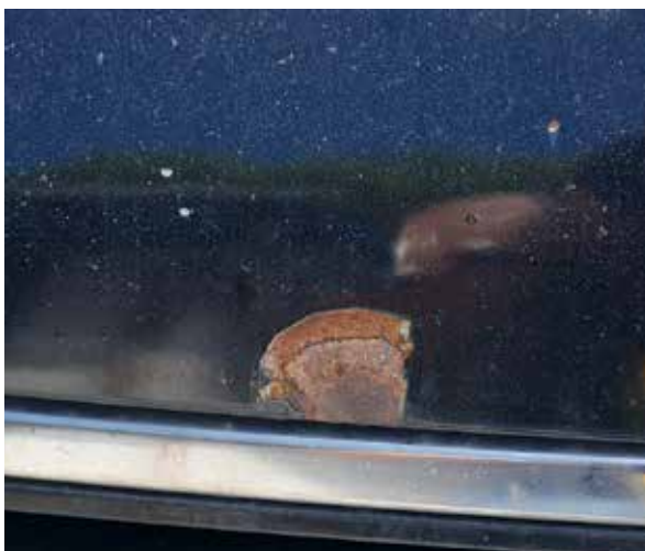
Veći udari kamena s korozijom
